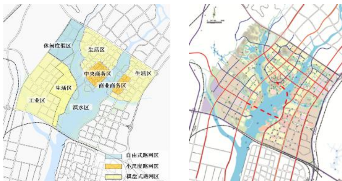
图 8 各功能分区路网选型（左）、远景隧道方案示意图（右）
